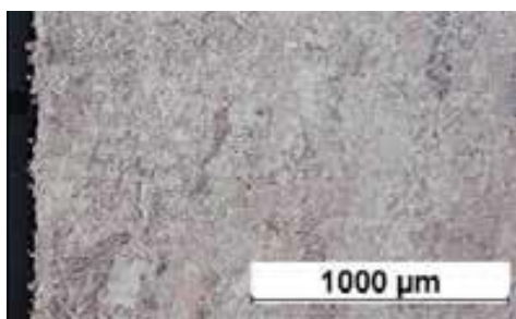
Mikrostruktur nach Wärmebehandlung
